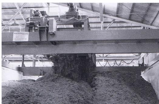
RYOKOの有機質堆肥醗酵プラントは、有機質廃棄物や畜糞尿の醗酵・分解のプロセス等を、人為的に最良の条件づくりを行い、狭いスペース・低コストで良質有機肥料を生産するスクープ式醗酵用攪拌装置です。主な特長は、
